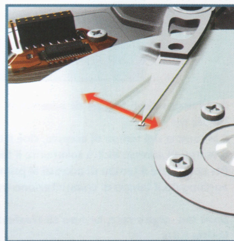
I bracci posizionano a grande velocità le testine di lettura sulle piste di ciascun disco.
